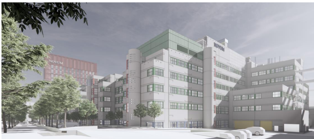
Figur 6. Koncept för tillbyggnad av fläktrum på befintliga Novum. Tillbyggnader på fläktrum görs i en kulör som bygger på befintlig byggnads gröna fönsterkulör. (Illustration Tengbom)
